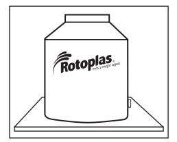
Denominamos apoyo plano, a toda superficie en la que el tanque está apoyado sobre una estructura de losa o similar, absolutamente plana y nivelada.
