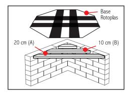
**B.** Si las paredes de apoyo construidas son en "L" o en "ángulo", colocar 3 vigas de 10 cm (B) a una distancia no superior a 20 cm entre ellas (A). Apoyar la Base Rotoplas. En este caso, no hace falta girar 10° ya que queda en la posición correcta. En ningún caso la base para tanque debe tener un voladizo mayor a 10 cm respecto de las paredes y vigas de apoyo.
