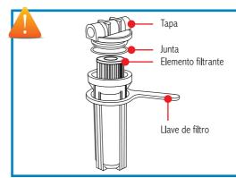
Verifique la correcta posición de la entrada rosca hembra ½" o ¾" (E) y salida rosca hembra ½" o ¾" (S) del agua, claramente indicada en la tapa del portafiltro en relación a la tubería. Considere dejar 15 cm entre el suelo o apoyo y la base del vaso portafiltro Rotoplas para facilitar la limpieza y el recambio del elemento filtrante. Recuerde que el lugar debe ser de simple acceso y protegido de posibles impactos.
