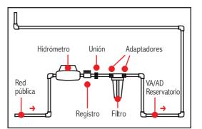
Al optar por la instalación entre las secciones de tubo sin soporte alguno, se debe utilizar un apoyo para no forzar este con su peso. Si es posible, instale el filtro con una ménsula que sujete la tapa del filtro.
