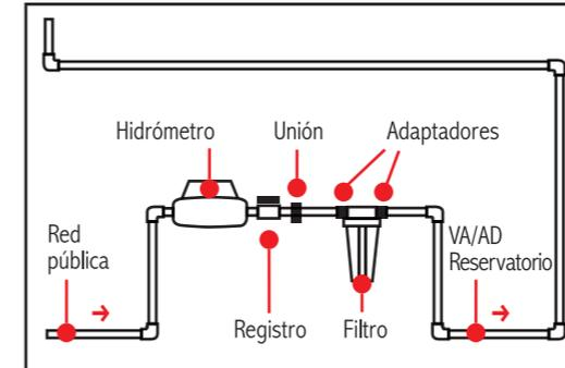
Al optar por la instalación entre las secciones de tubo sin soporte alguno, se debe utilizar un apoyo para no forzar este con su peso. Si es posible, instale el filtro con una ménsula que sujete la tapa del filtro. Aplique cinta de teflón en el tubo roscado (si es necesario en adaptadores). En caso de ser necesario un ajuste mayor, utilice una herramienta para girar suavemente sobre el tubo, un máximo de 3/4" de vuelta, es suficiente.
