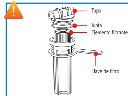
Verifique la correcta posición de la entrada rosca hembra 1/2" o 3/4" (E) y salida rosca hembra 1/2" o 3/4" (S) del agua, claramente indicada en la tapa del portafiltro en relación a la tubería. Considere dejar 15 cm entre el suelo o apoyo y la base del vaso portafiltro Rotoplas para facilitar la limpieza y el recambio del elemento filtrante. Recuerde que el lugar debe ser de simple acceso y protegido de posibles impactos.
