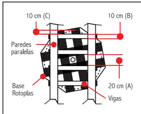
A. Si ésta se realiza sobre paredes paralelas, colocar 4 vigas de 10 cm de ancho cada una (B), a una distancia entre sí que no supere los 20 cm (A). Apoyar la Base Rotoplas correspondiente al modelo del tanque y girarla 10° respecto de las vigas. Para mayor seguridad sujetar con dos grampas omega a las paredes o vigas para evitar cualquier desplazamiento al apoyar el tanque. En ningún caso la base para tanque debe tener un voladizo mayor a 10 cm (C) respecto de las paredes y vigas de apoyo.
