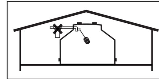
Incluido en tanques Rotoplas línea Clásica de 1100 y 2750 lts y línea Flat de 1000 lts. (Accesorio opcional en resto de las líneas y capacidades). Se indica la instalación del filtro en un lugar de fácil acceso, en cualquier punto de la cañería entre la red de suministro y la entrada al tanque para agua.
