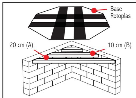
B. Si las paredes de apoyo construidas son en "L" o en "ángulo", colocar 3 vigas de 10 cm (B) a una distancia no superior a 20 cm entre ellas (A). Apoyar la Base Rotoplas. En este caso, no hace falta girar 10° ya que queda en la posición correcta. En ningún caso la base para tanque debe tener un voladizo mayor a 10 cm respecto de las paredes y vigas de apoyo.
